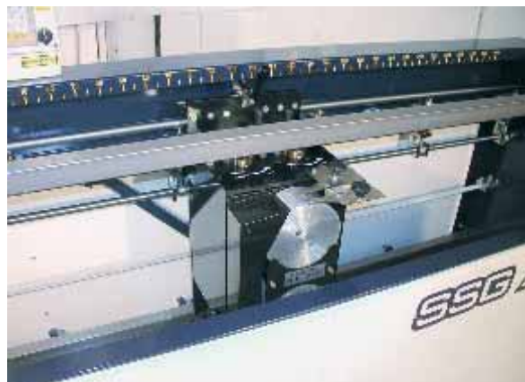
Detailní pohled na brusnou hlavu, která odebrá materiál postupně ve velmi malém množství
