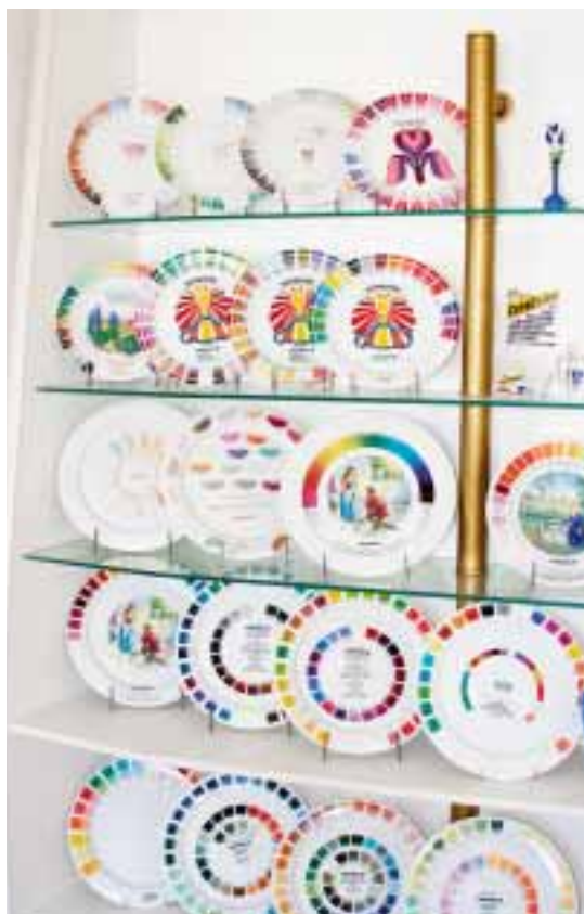
Vzorníky jsou v oblasti potisku skla velmi důležitým pomocníkem zejména z toho důvodu, že barvy mění po vypálení svůj odstín
