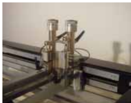
Detail těrkového vozu, nastavení těrky a předtěrky
