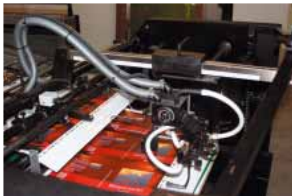
Nakládání savkovou hlavou je podobné jako u archových ofsetových tiskových strojů
