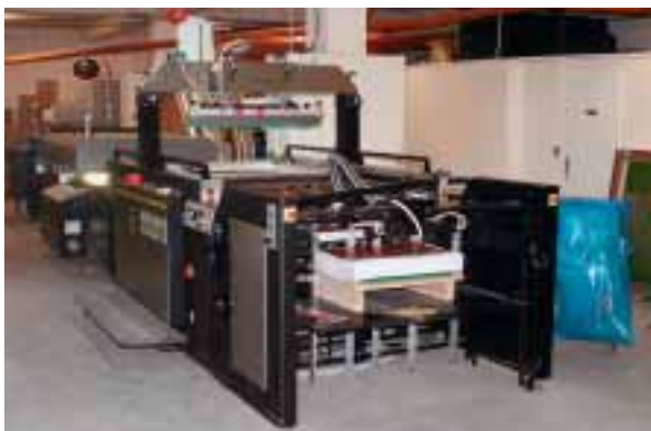
Typickým představitelem výkonných tiskových systémů s tiskem prováděným proti válci jsou zařízení od společnosti SPS Rehmus
