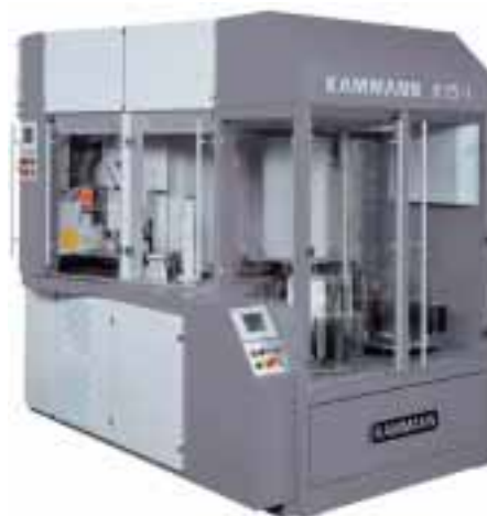
Kromě rovinného uspořádání lze u těchto strojů využít i karuselové konstrukce
