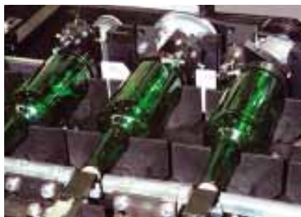
Při potisku lahví je nutné přesné uchycení jednotlivých produktů
