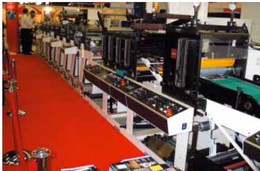
Rotační sítotisková forma se v úzkoformátovém flexotiskovém stroji velmi často používá v kombinaci s dalšími tiskovými technikami
