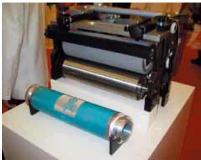
Detailní pohled na sítotiskovou kazetu, která je plně zaměnitelná s kazetami ostatních tiskových technik
