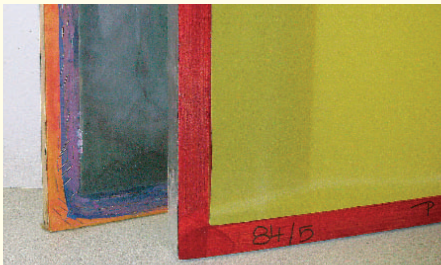
Síta jsou na rámy nejčastěji připevňována lepením dvousložkovým lepidlem
