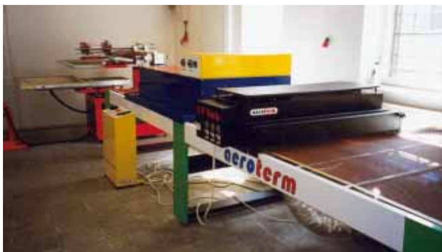
UV vytvrzovací tunel, připojený za sítotiskovým strojem
